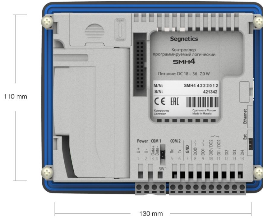
Рис. 7 – Установочные размеры контроллера
